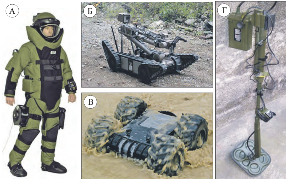
Образцы ВВТ инженерных войск ВС Франции: А – защитный костюм сапера «Эод»; Б – инженерный РТК «Пакбот»; В – РТК «Минирожен»; Г – ручной миноискатель «Дхпм»
