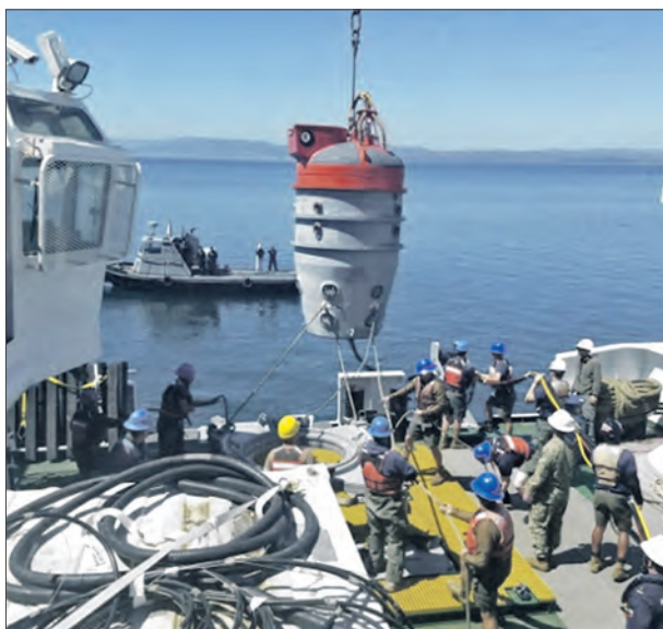
Спасательная камера Мак-Кенна ВМС США на двусторонних американо-чилийских учениях «Чилимар» по спасению экипажа ПЛ ВМС Чили (октябрь 2017 г.)
