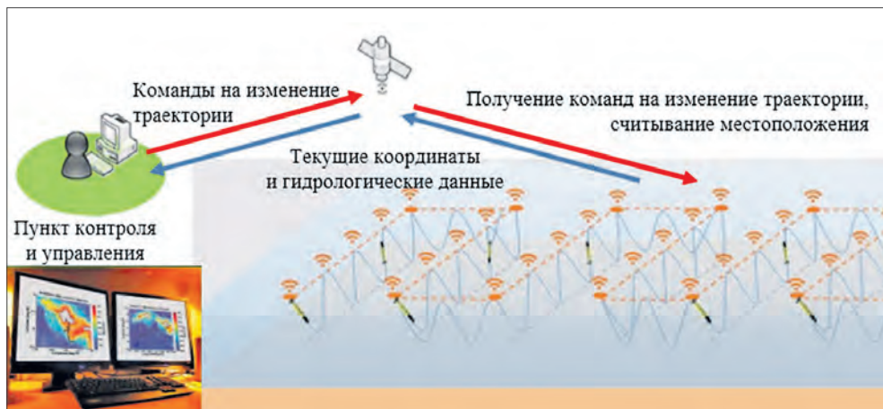
Подводный глайдер, схема движения и порядок поддержания связи с ним
