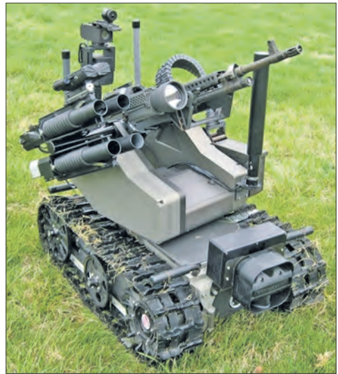
Боевая автономная роботизированная машина MAARS (Modular Advanced Armed Robotic System). На башне робота установлен пулемет M240В калибра 7,62 мм и четыре 40-мм гранатомета
