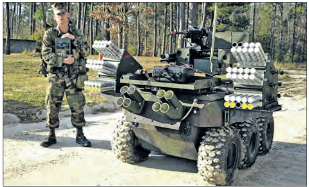
Американский радиоуправляемый боевой робот «Гладиатор» TUGV состоит на вооружении морской пехоты США. Оснащен прибором ночного видения и тепловизором, благодаря чему способен действовать в любое время суток
