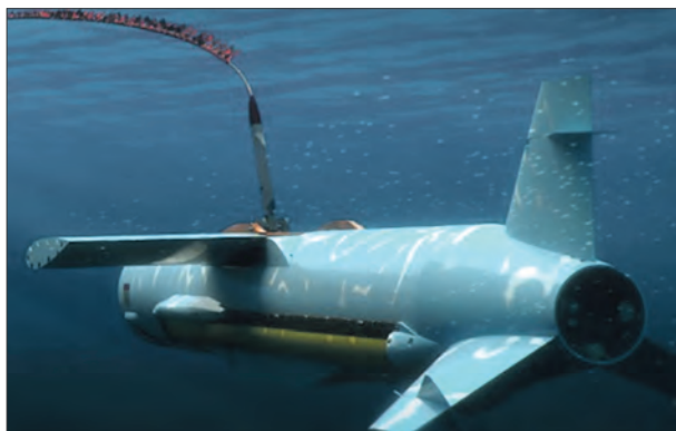
Буксируемый ПНПА AN/AQS-20C гидроакустической системы поиска мин и миноподобных объектов ВМС США
